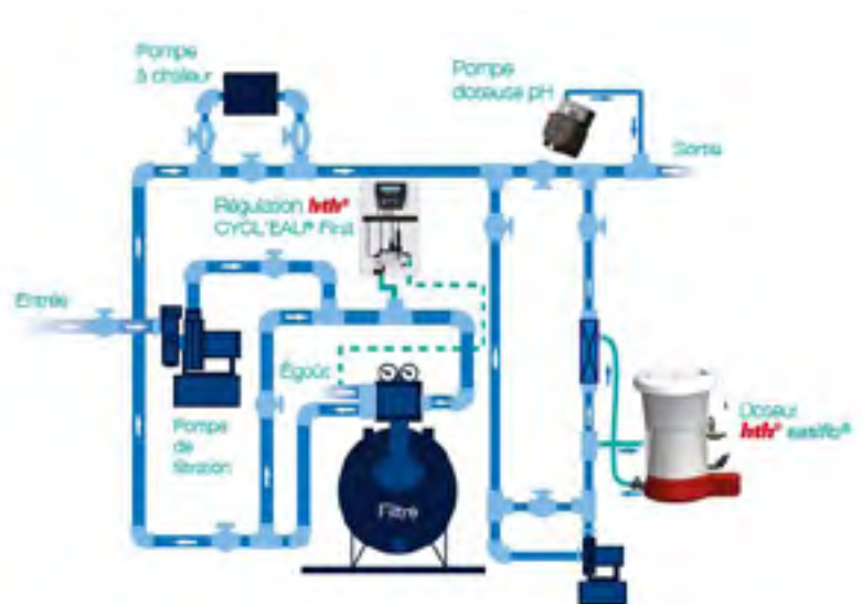
Schéma d'installation régulation ampérométrique hth® CYCL'EAU® FIRST avec un doseur hth® easiflo® SYSTEM
